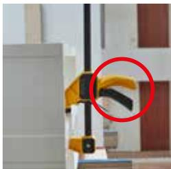
**Riziko poškození výrobku a zranění** se zvyšuje při použití upínacích nástrojů s vyčnívajícími součástmi v omezeném pracovním prostoru.
