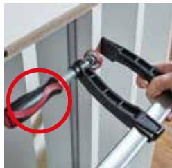
**Зажим деталей на узком участке** может вызвать проблемы в использовании классических винтовых и рычажных струбцин, поскольку их ручки мешают нужному расположению инструментов.
