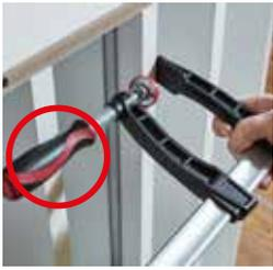
**Il serraggio in spazi angusti** può comportare problemi se si utilizzano strettoio a leva o a vite tradizionale, in quanto la maniglia impedisce di posizionare correttamente il strettoio.
