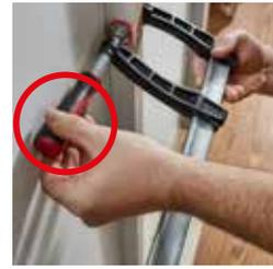
**Il serraggio davanti a una superficie chiusa** non è possibile utilizzando i classici strettoio a vite e a leva, in quanto non è possibile azionare la maniglia.
