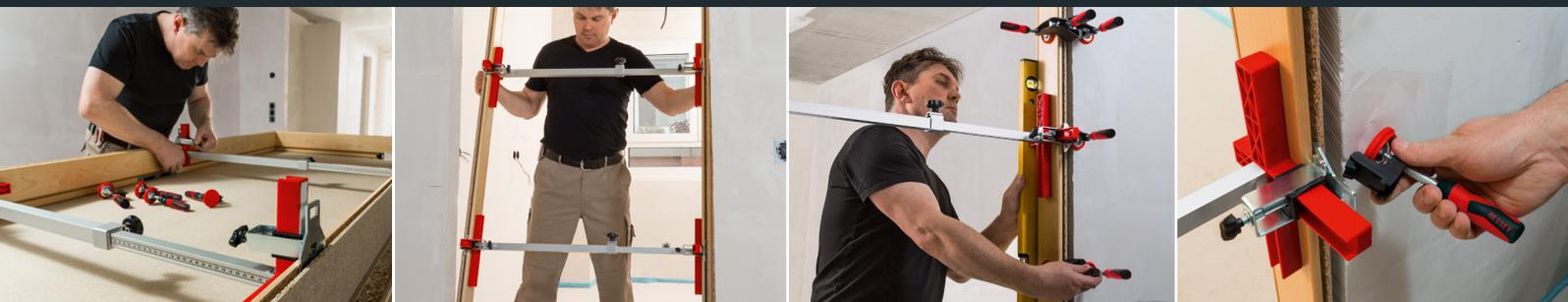
Zwei Aktionssets mit Türfuttermontage-Werkzeugen – zum exakten Ausrichten und Abstützen von Türfuttern
